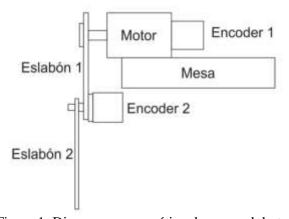
Figura 1. Diagrama esquemático de un pendubot.
